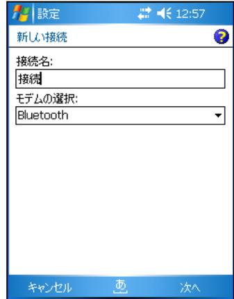
次に TerraSync ソフトウェアのリアルタイム接続ソースに接続する場合、ハンドヘルドは Bluetooth 接続で携帯電話に接続し、基準局または VRS にダイアルします。
