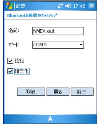
これで本体のアプリケーションはこのサービス用に選択した COM または BSP ポートを使用できるようになりました。例えば、一体型 GPS 受信機から Bluetooth クライアントに NMEA メッセージを提供するには、GPS Connector ソフトウェアを使用して COM2 の NMEA 出力を、このサービス用に割り当てたバーチャルシリアルポートまたは Bluetooth ポートに連結します。
