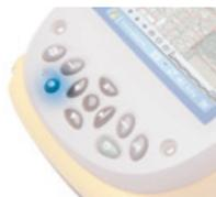
表示ボタンは、バックライトコントロールでの設定より優先されます。バックライトを再びオンにするには、**表示ボタン**を使用します。
